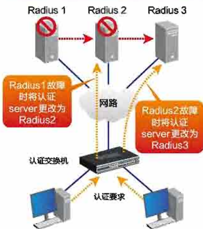
Multi Radius server 登录机制 最多可设定 3 台 Radius server
