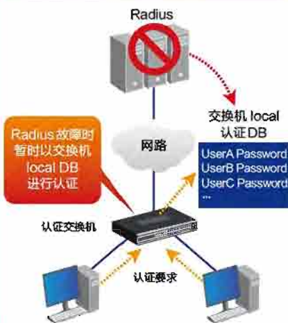
认证 DB Fail Over 机制 Radius 故障时切换至、交换机 local 认证
